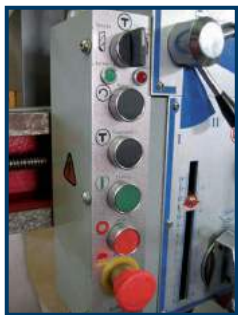
autom. Gewindegewandeneinrichtung und zentrales Schaltpanel
